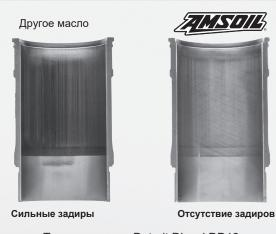
Тест на задиры Detroit Diesel DD13 по спецификации DFS 93K222
